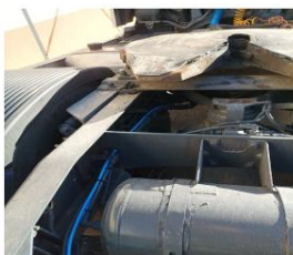
TUBOS DE AIRE UNIDOS CON BRIDAS PARA SU PROTECCIÓN
