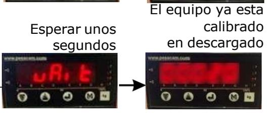
El indicador nos puede mostrar un valor numérico o bien un mensaje de error (OL), esto es normal y puede permanecer así hasta que lo calibremos con carga.
