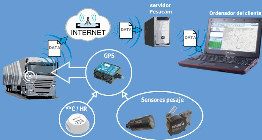
Completo sistema para controlar y monitorizar los parámetros de tu camión, desde la temperatura y / o humedad de la carga, el peso, apertura de puertas, etc...
